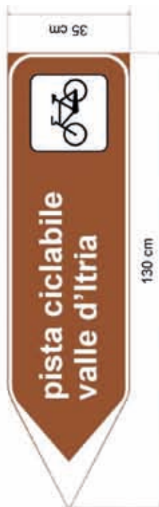
Fig 1: Segnale di direzione avviamento a itinerario ciclopedonali ottenuto dai segnali turistici per contesti extraurbani (Tabella II 14a DPR 495/92)
