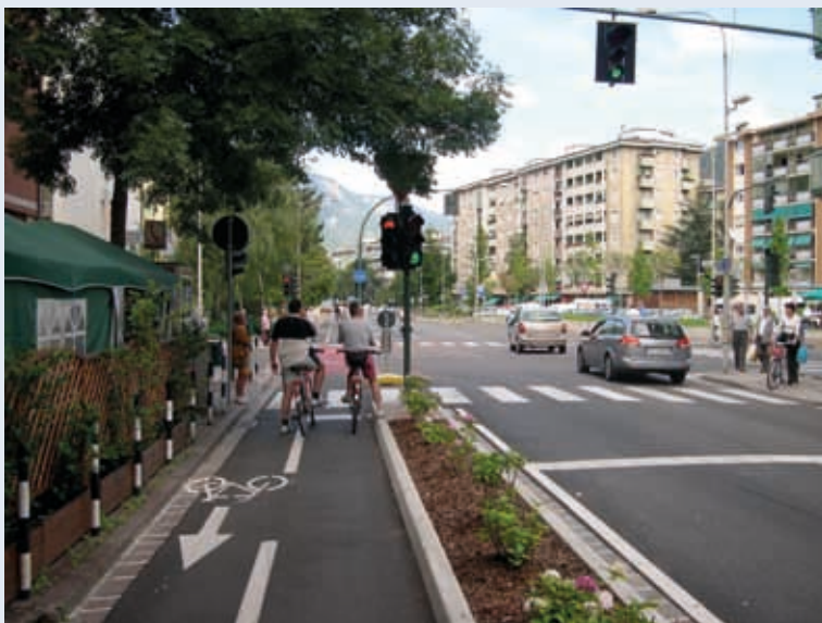
BOLZANO. ELEMENTO SEPARATORE REALIZZATO CON DOPPIO CORDOLO E RIEMPIMENTO VERDE.
