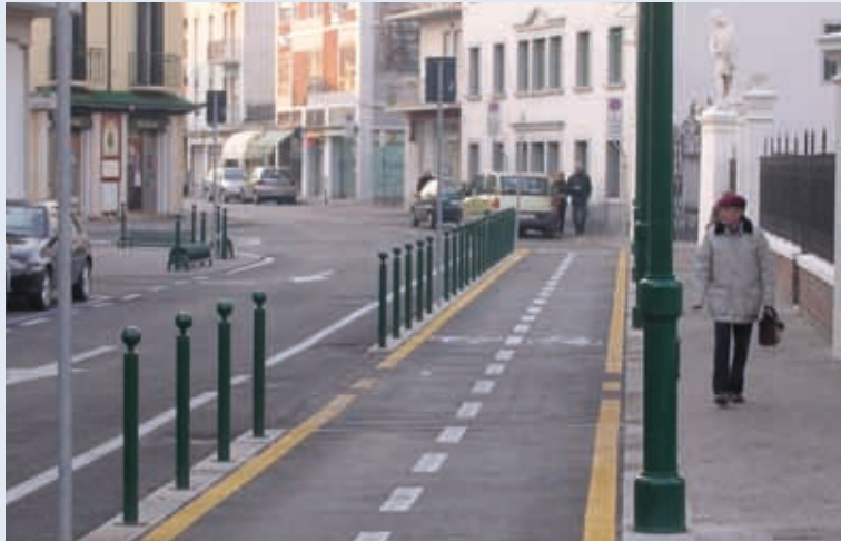
MESTRE, VIA VERDI. ELEMENTO SEPARATORE OTTIMALE IN VICINANZA DI TRAFFICO LEGGERO E ALTA PEDONALITÀ TRAVERSANTE
