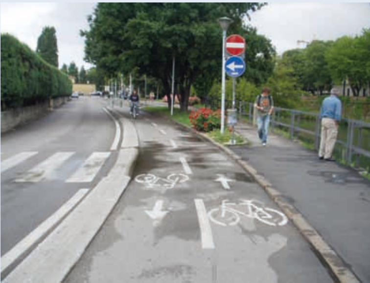
PADOVA. ELEMENTO SEPARATORE REALIZZATO CON DOPPIO CORDOLO CORICATO
