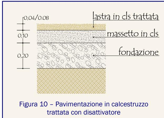
Figura 10 – Pavimentazione in calcestruzzo stampato con disattivatore
