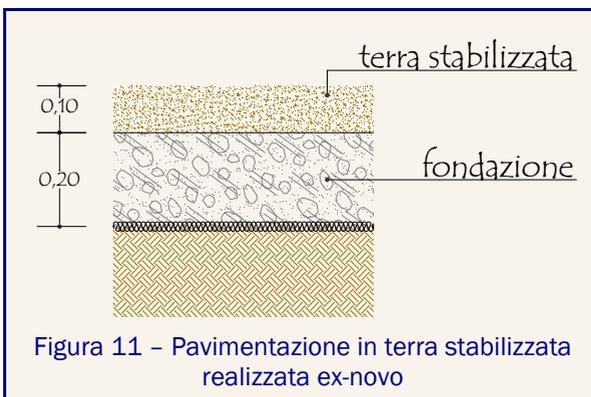
Figura 11 – Pavimentazione in terra stabilizzata realizzata ex-novo
